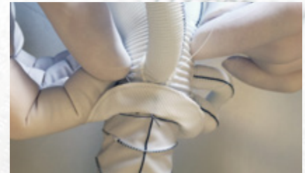
handmatige productie van een vaatprothese
